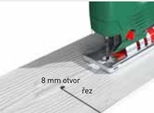
V případě rohového výřezu musí být ve vnitřním rohu vyvrtán otvor min. 8 mm, aby se zabránilo zlomení desky.
