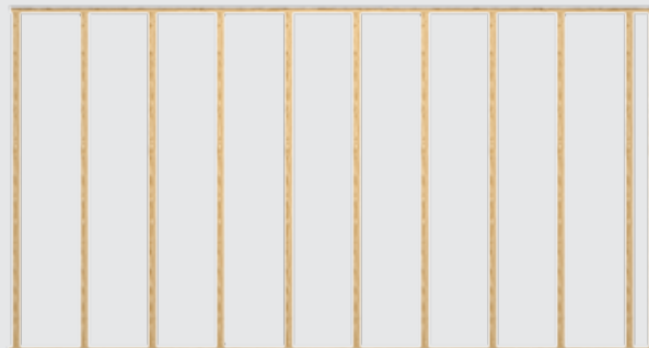
Osová vzdálenost spodní konstrukce max. 500 mm
