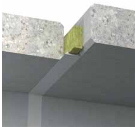
Horizontální spára v masivním stropě
