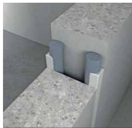
Vertikální spára v masivní stěně
