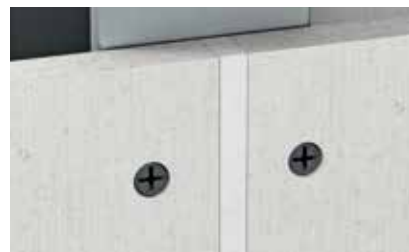
Tmelená spára fermacell™ – šířka spáry: \frac{1}{2} \times tloušťka desky + max. 3 mm
