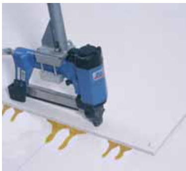
Obrázek 5: spojení obou vrstev sponkami
