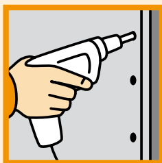
Upevnění šroubování na kovovou spodní konstrukci
